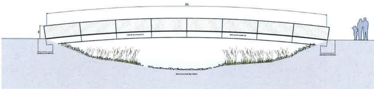
La passerelle aura un profil légèrement arqué avec une pente maximale de 6 % permettant ainsi une compatibilité vis-à-vis de l'accès des personnes à mobilité réduite.
