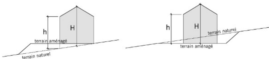
Fig. 2 : Schéma explicatif du calcul de la hauteur à partir du terrain naturel ou aménagé
